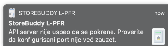
Slika 42: API server nije mogao da se pokrene jer je konfigurisan port već zauzet.
